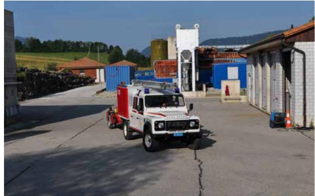
Le véhicule de 1<sup>ère</sup> intervention est composé d'un véhicule tracteur et d'un moyen hydraulique. Ce concept permet un engagement rapide et léger dans les premières minutes avant l'arrivée d'éventuels moyens lourds en fonction des besoins.
